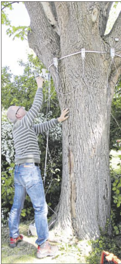
Vorbereitung der Querschnittsmessung.
